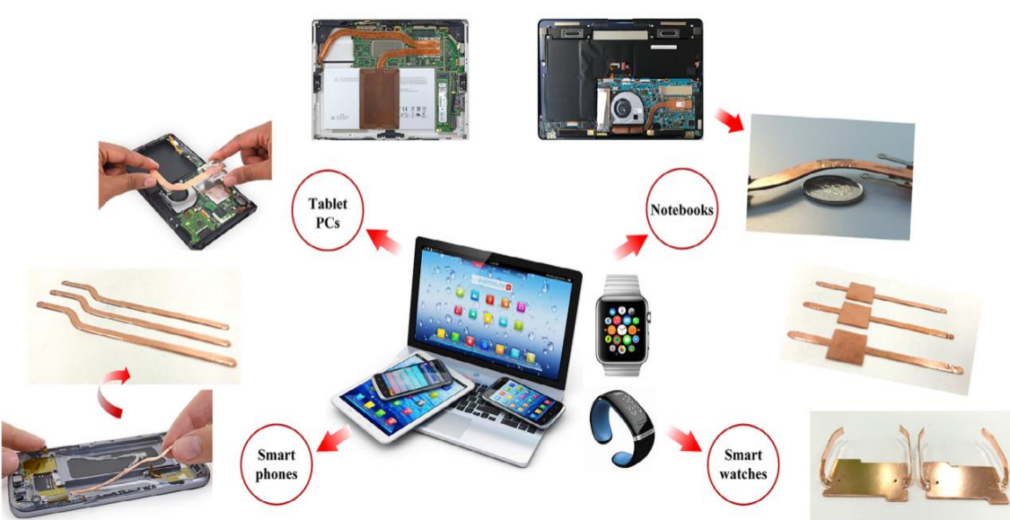
图 9：热管在终端设备散热中的应用
